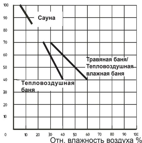
Отображенная на дисплее интенсивность влажности соответствует пропорциональной по времени настройке испарителя. Поэтому на дисплее задается/отображается не относительная влажность воздуха, а частотность включения испарителя в процентах. График дает более четкое представление.
