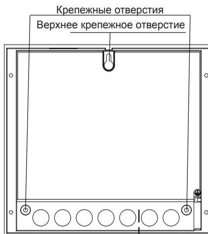
Отверстия для следующих проводов: Сетевая подводка; Подводящий провод печи; Подводящий провод испарителя Лампа; Вентилятор
