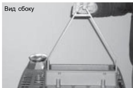
2. Проверьте, чтобы пальцы полностью входили в отверстия для обеспечения стабильного крепления.
