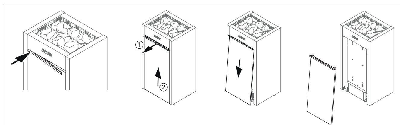
Рисунок 5. Открывание крышки сервисного отсека
