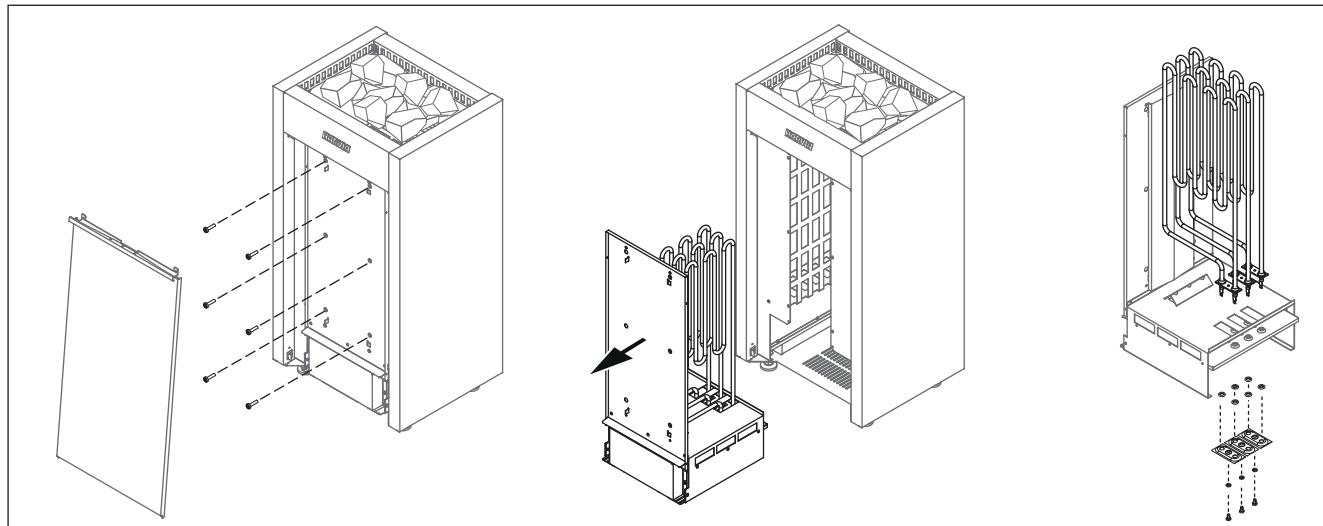
Рисунок 8. Замена нагревательных элементов
