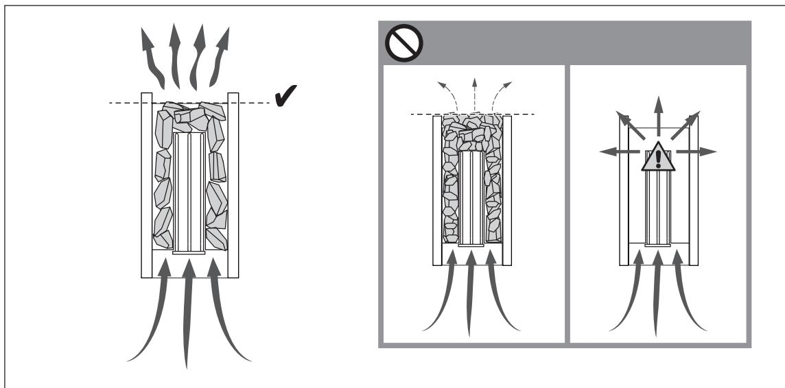
**Рисунок 1. Укладка камней**
