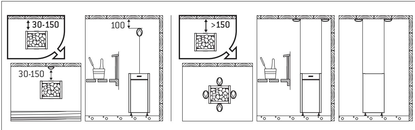
**Рисунок 6. Установка датчиков (все размеры приведены в миллиметрах)**
